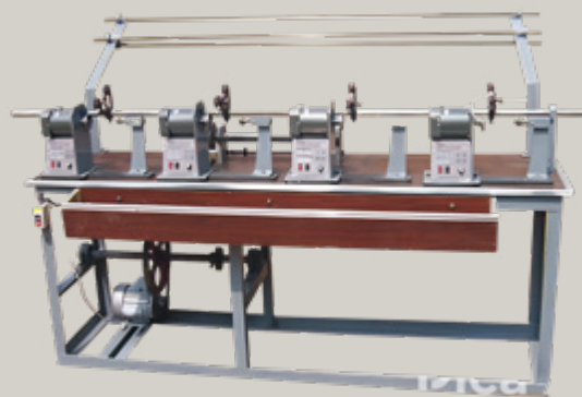
Máquina semiautomática de bobina de 4 cabezas
